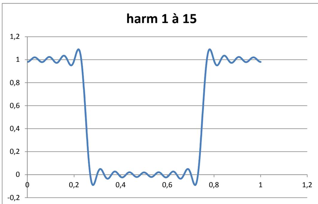
Le graphe de la fonction à synthétiser est déjà quasiment reconstitué, le signal obtenu s'identifie pratiquement à un signal créneau.
