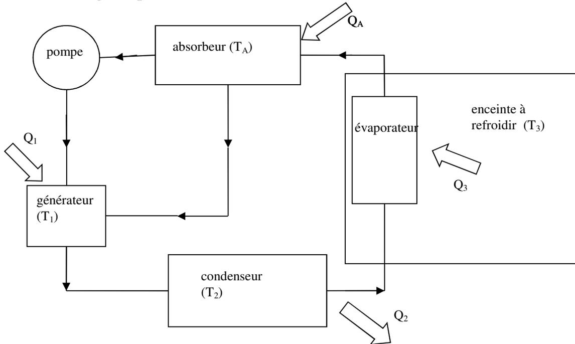
a) b) L'intérêt du réfrigérateur est d'extraire  $Q_3$  de l'enceinte à refroidir. Il consomme  $Q_1$  au niveau du générateur. Son efficacité est :  $\eta = Q_3 / Q_1$ .
