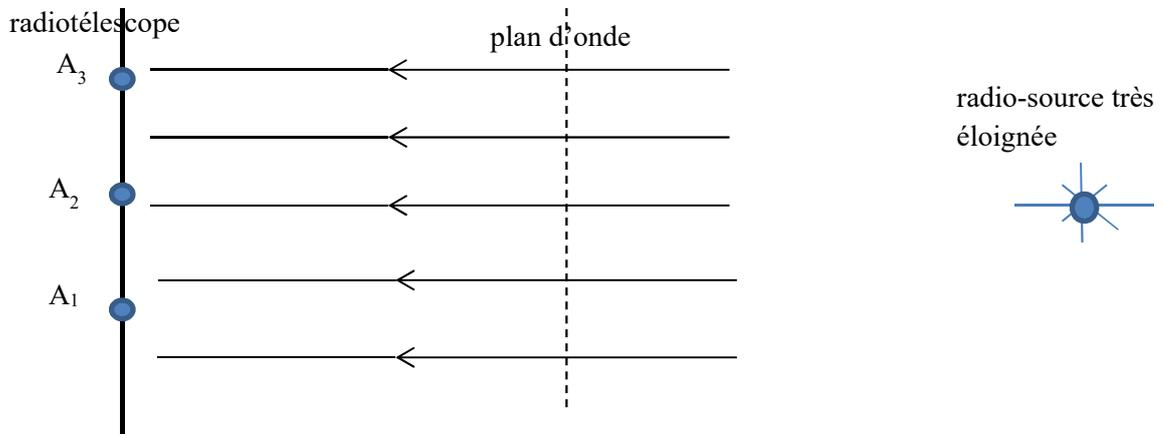
Quand le radiotélescope pointe exactement sur la radiosource (schéma ci-dessus) les plans d'onde, orthogonaux à la direction de propagation, sont parallèles aux antennes de réception ( $A_1$ ,  $A_2$  etc...). Les signaux reçus par les antennes sont alors en phase. Leur superposition correspond à une interférence constructive, le signal somme est donc d'amplitude maximal.
